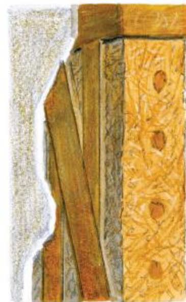
mur en pan de bois et torchis enduit à la chaux
